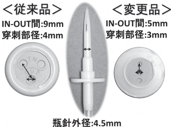
図 2. リハビックス K1 号輸液のゴム栓部の形状比較 (従来品 - 変更品)
